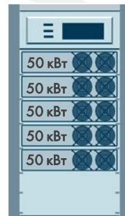
Модульный ИБП 5 * 50 кВт
