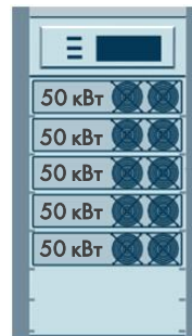
Модульный ИБП 5 * 50 кВт
